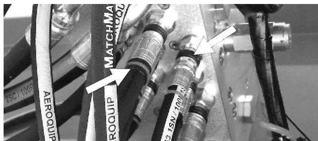
Abbildung 7.14 - Armaturen am Ventil prüfen
