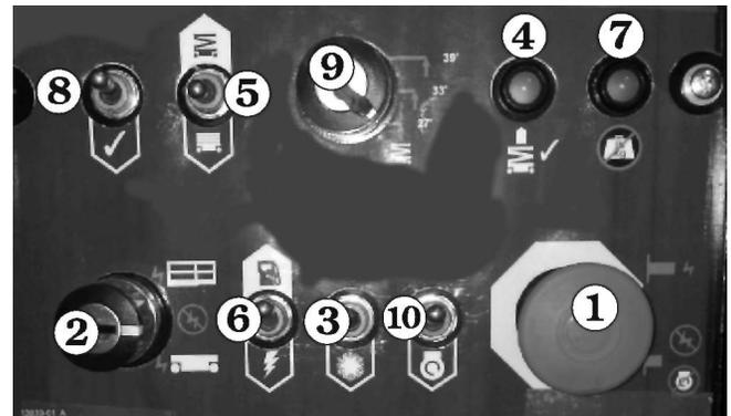
Abbildung 6.3 - Bedienelemente des Boden-Schaltkastens
