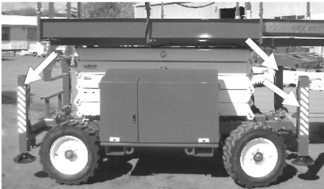
Abbildung 2.11 - Stabilisatoren
