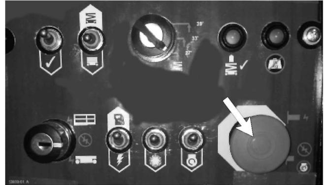
Abbildung 2.2 - Notaus-Schalter am Boden-Schaltkasten
