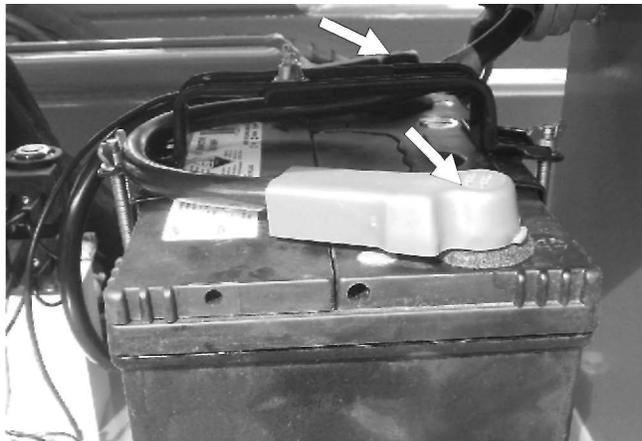
Abbildung 7.12 - Batterieklemmen
