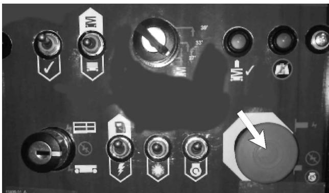
Abbildung 9.2 - Notaus-Schalter am Boden-Schaltkasten
