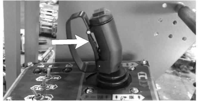
Abbildung 2.8 - Steuerknüppel-Sicherheitssteuerung
