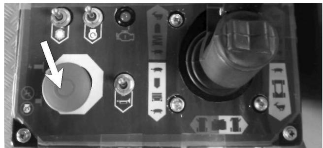
Abbildung 8.2 - Notaus-Schalter am Plattform-Schaltkasten
