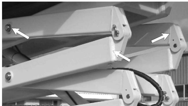
Abbildung 7.19 - Strukturschäden und Schweißnähte
