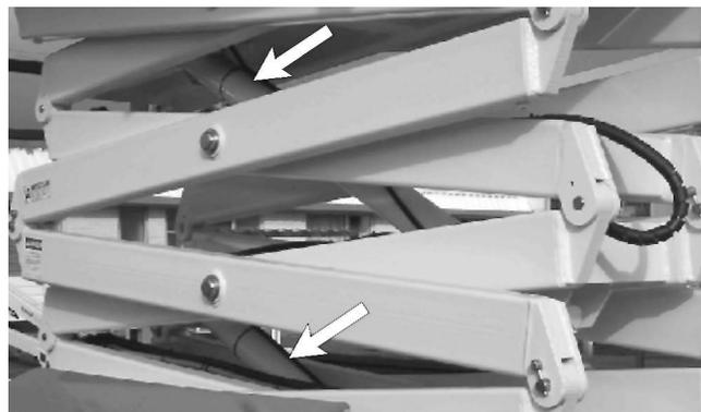
Abbildung 7.15 - Hydraulikzylinder prüfen
