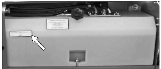
Abbildung 4.4 - Hydraulikölstand
