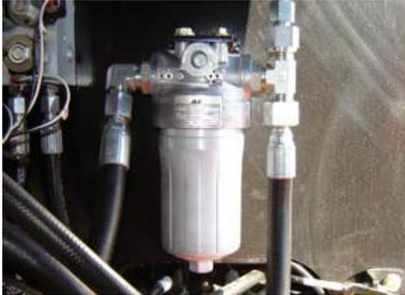
Intervall: Nach den ersten 50 Stunden und danach alle 6 Monate oder 300 Stunden oder nach Angabe der Zustandsanzeige ersetzen
