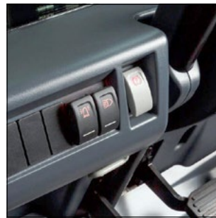
Elektrisch betätigte Parkbremse, Bedienung einfach per Knopfdruck
