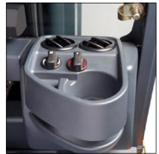
Heizung inklusive Luftausströmer für Frontscheibe
